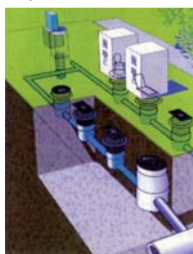
地下埋設の非常用便槽
